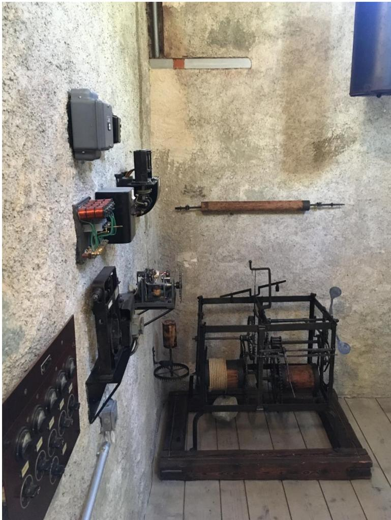
Abb.: Saniertes Uhrwerk mit Komponenten der ersten elektrischen Schlagsteuerung im Innern des Turms (Bauamt St. Moritz)
